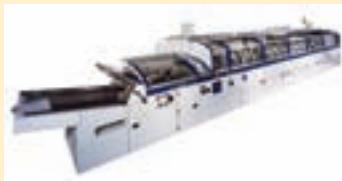
毎時1万5千冊の高速製本を行う、ドイツ製の無線綴製本機を設置し、印刷と製本の連携体制を強化いたします。
