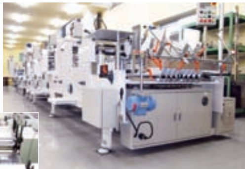
折り、糊付け、組み立てを自動で行うサックマシン
